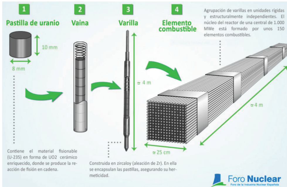
Figura 3. Las pastillas de UO_2 enriquecido se introducen en vainas, las cuales se fijan con el soporte de varillas. Las varillas se agrupan constituyendo elementos de combustible nuclear. Fuente: Foro nuclear, Foro de la Industria Nuclear Española.
