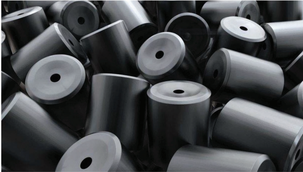
Figura 2. El UF_6 enriquecido se transforma en polvo de UO_2 que se compacta en pastillas cilíndricas cerámicas de 1cm de diámetro por 1cm de alto (aprox.) con características estables a las temperaturas que soportarán en el reactor nuclear. Fuente: Foro nuclear, Foro de la Industria Nuclear Española.
